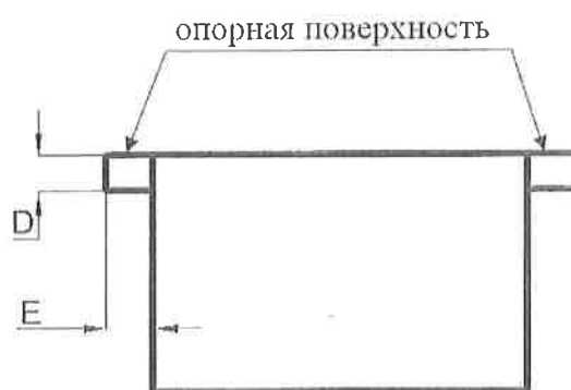
Рисунок 5 – Обозначение размеров опорной поверхности
